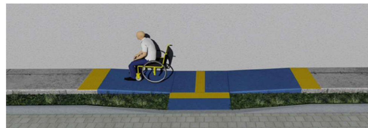
Persp. ilustrativa - Rampa estreita com canteiros escala 1:50
